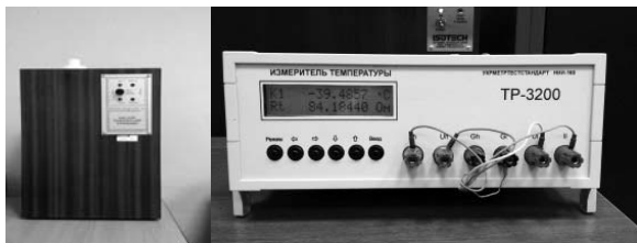
Рис. 3. Апарат для реалізації та підтримання точки плавлення галію 17402B та багатофункціональний термометричний міст TP-3200
