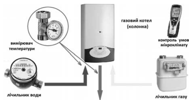
Рис. 4. Структурні елементи схеми способу експрес-контролю теплоти згоряння природного газу в споживача комунально-побутового сектору Fig. 4. Structural elements scheme the express method of natural gas heat of combustion to domestic household sector consumer
