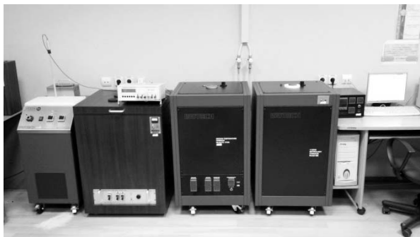
Рис. 1. Зовнішній вид вторинного еталона одиниці температури
