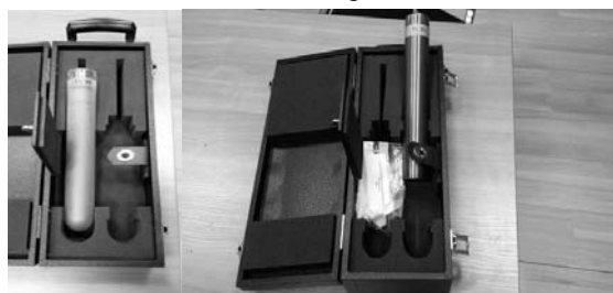
Рис. 4. Ампули точок затвердіння Cu65 та Al311
