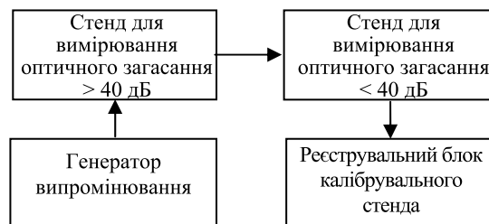
Рис.14. Блок-схема установки для МА
