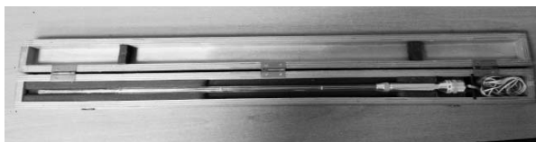
Рис. 2. Високотемпературний термометр опору платиновий еталонний BTC № 173
