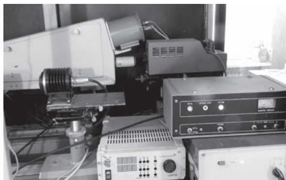
Рис. 4. Джерела лазерного випромінювання установки для повірки дозиметрів лазерного випромінювання на довжинах хвиль 0,63 і 0,8 мкм
