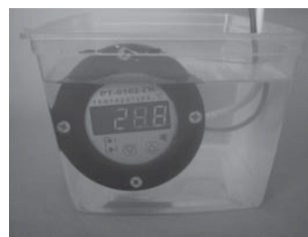
а) водостійкий корпус PT-0102
