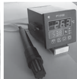
г) термогігрометр на базі PT-0102 (Щ2) з ємнісним перетворювачем вологості
