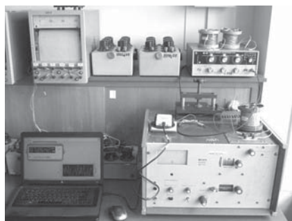
Рис. 8. Робоче місце проведення експерименту з віртуальним вольтметром
