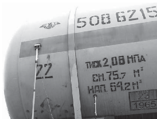
Рис. 2. Місця установлення термодатчика й антени Analіq-M за вимірювання ШЗ
