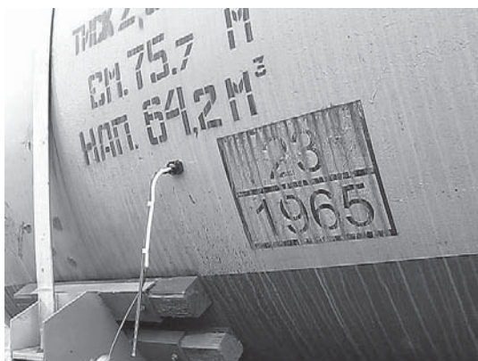
Рис. 2. Місця установлення термодатчика й антени Analіq-M за вимірювання ШЗ
