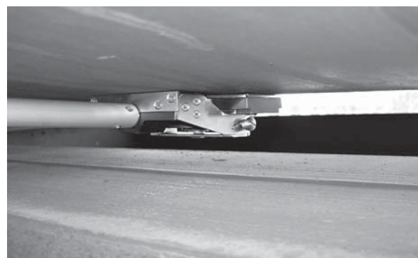
Рис. 4. Місце встановлення антени за вимірювання рівня
