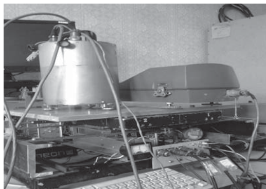
Рис. 8. Одночасний процес калібрування двох приладів різної моделі для вивчення властивостей сейсмометричних каналів та системи фіксації часу в сейсмічних записах за допомогою GPS-пристроїв різних моделей
