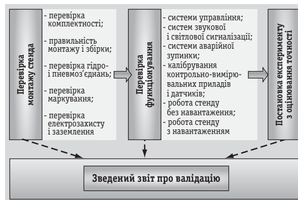
Рис. 3. Операційні процедури валідації стенда для випробувань фрикційних пар
