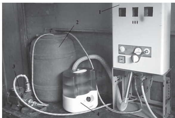
Рис. 1. Експериментальний стенд: 1 — водогрійний котел Протон — 3; 2 — ємність з водою; 3 — електронасос; 4 — парогенератор
