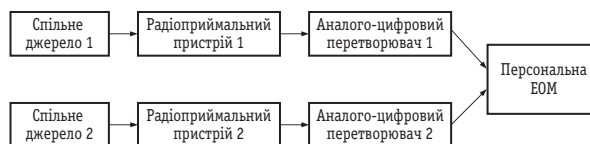
Рис. 2. Структурна схема апаратури для взаємної прив'язки сигналів двох загальних джерел
