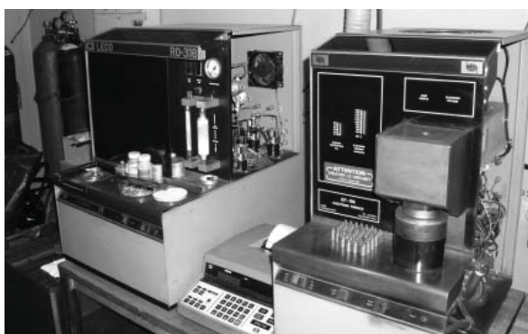
Рис. 1б. Прилад RO-316 (фірма «LECO» США) для визначення вмісту кисню у металах
