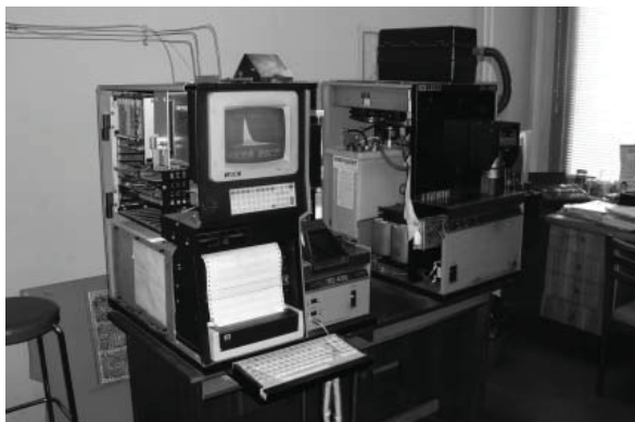
Рис. 1а. Прилад ТС-436 (фірма «LECO» США) для визначення вмісту кисню та азоту у металах
