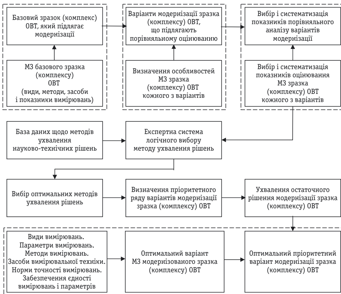
Логіко-структурна схема процесу визначення оптимального варіанта модернізації зразка (комплексу) ОВТ
