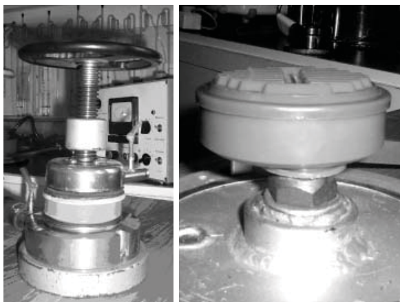
Рис. 8. Розміщення фільтра для визначення перепаду тиску:
