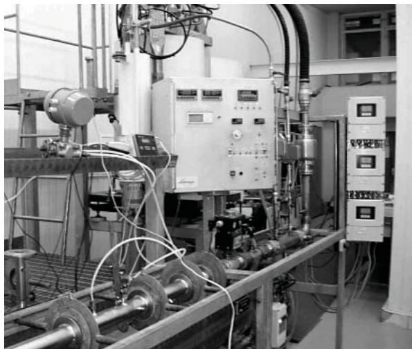
Рис. 2. Трубка Піто з координатною прив'язкою у перерізі
