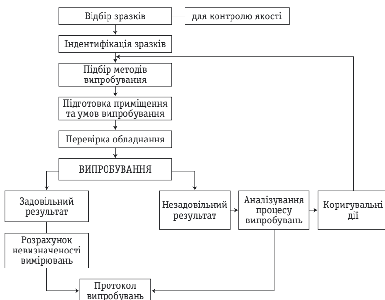
Рис. 5. Принципова схема випробування ЗІЗОД
