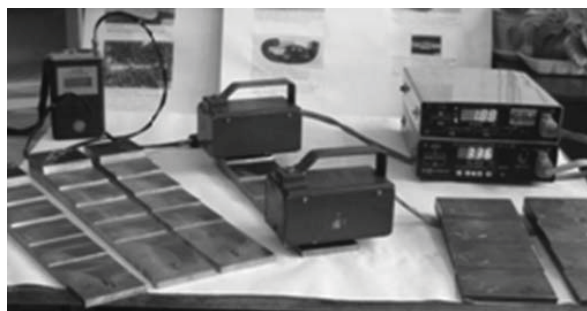
Проведення порівняльних вимірювань H_C^0 на зразках-еталонах (зі змінним перетином) різними структуроскопами
