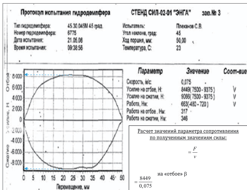
Рис. 3. Вид протоколу оформлення результатів випробувань гідродемпфера коливаний типу 45.30.045М на стенді «ЭНГА» типу СИЛ-02-01 (Росія)
