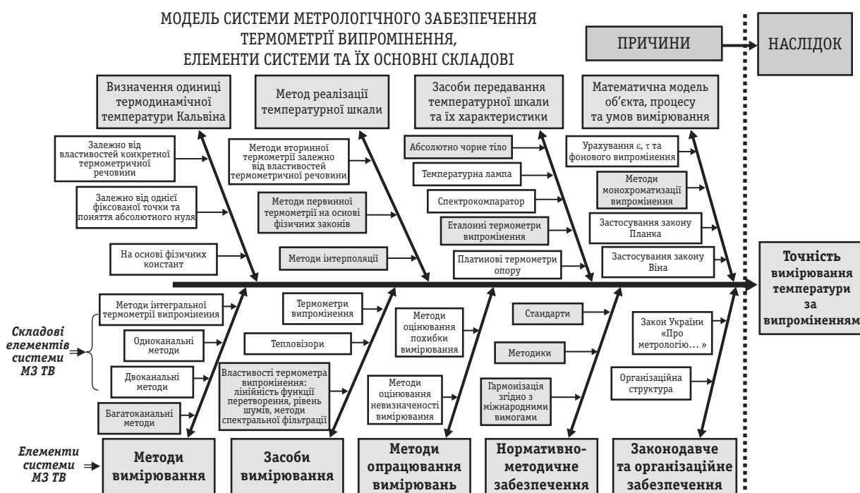
Рис. 1. Причинно-наслідкова діаграма впливу елементів системи МЗ ТВ та їх складових на точність вимірювання температури за випроміненням
