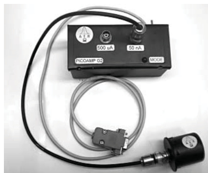
Рис. 5. Зовнішній вид пікоамперметра для дослідження малих струмів напівпровідникових елементів
