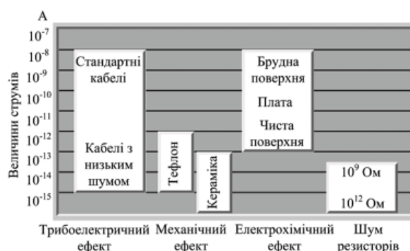
Рис. 2. Типові величини струмів, що зумовлюють похибки вимірювання
